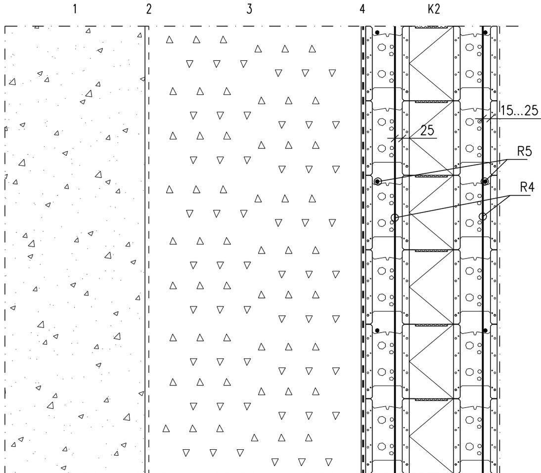
K2 Kantava rakenne ladottava lämpöharkko
