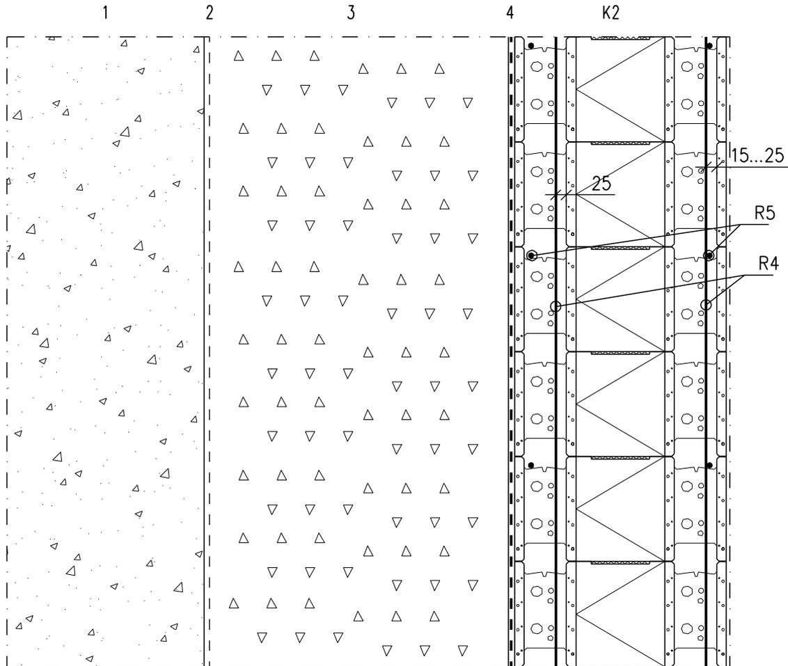
K2 Kantava rakenne ladottava lämpöharkko
